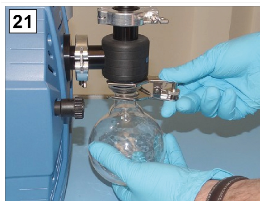
21. Fiksirajte stekleni bat na vhod IN.
