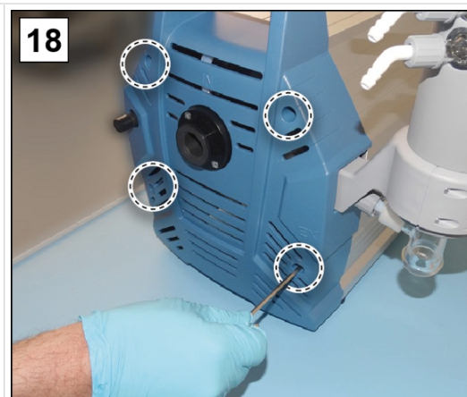
18. Privijte vijake dela ohišja; inbus ključ vel. 4.
