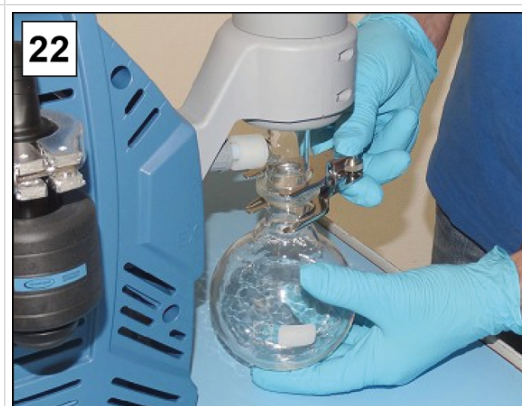
22. Fiksirajte stekleni bat na EK.
