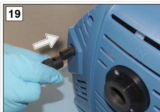
19. Nataknite kapico na plinski balast.
