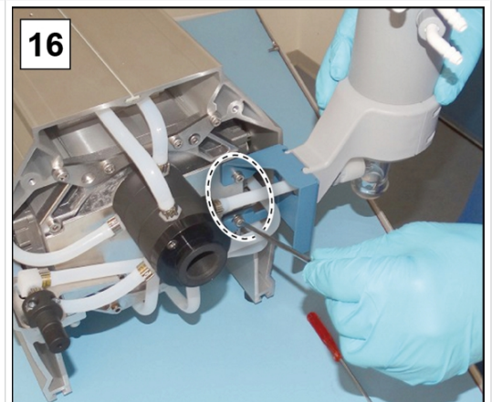
16. Aparafusar os 2 parafusos do suporte EK; chave Allen tamanho 4.
