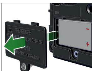
**IMPORTANTE!** Gli strumenti ausiliari utilizzati per estrarre la batteria non devono provocare cortocircuiti.
