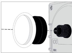
1. Applicare la flangia piccola KF DN16 sull'attacco per il vuoto dello strumento di misura.
