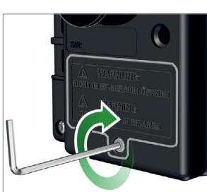
4. Riapplicare il coperchio del vano batteria con la vite nella posizione giusta sullo strumento di misura e avvitare la vite a mano. Osservare la coppia torcente massima di 0,4 Nm per l'avvitamento.
