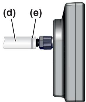
3. Spingere il raccordo ondulato per flessibili con il dado di raccordo nell'attacco per il vuoto dello strumento di misura e stringere bene il dado di raccordo.
