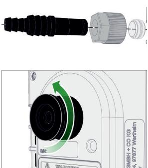
1. Se montata, svitare la flangia piccola dall'attacco per il vuoto dello strumento di misura.
