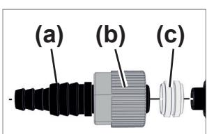
2. Collegare il raccordo ondulato per flessibili (a), il dado di raccordo (b) e l'anello di tenuta (c) nella maniera indicata.
