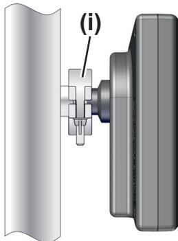
4. Posizionare lo strumento di misura con l'anello di centraggio sull'attacco dell'apparecchiatura → flangia piccola KF DN16.
