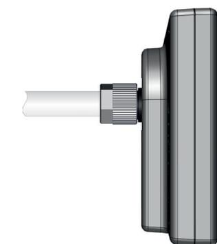
3. Spingere il flessibile in PTFE con il dado di raccordo nell'attacco per il vuoto dello strumento di misura e stringere bene il dado di raccordo.
