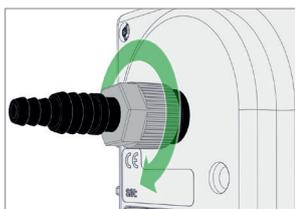
3. Spingere il raccordo ondulato per flessibili con il dado di raccordo nell'attacco per il vuoto dello strumento di misura e stringere bene il dado di raccordo.
