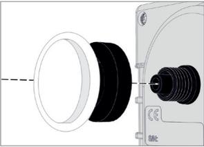
1. Applicare la flangia piccola KF DN16 sull'attacco per il vuoto dello strumento di misura.
