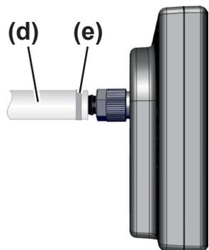
4. Spingere il flessibile del vuoto (d) dall'apparecchiatura sul raccordo ondulato per flessibili e fissare il flessibile del vuoto, ad es. con una fascetta stringitubo (e).
