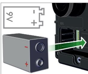
3. Inserire la nuova batteria nel vano con la giusta polarità (confrontare con il grafico nell'alloggiamento).
