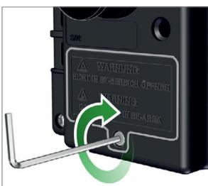
4. Riapplicare il coperchio del vano batteria con la vite nella posizione giusta sullo strumento di misura e avvitare la vite a mano. Osservare la coppia torcente massima di 0,4 Nm per l'avvitamento.
