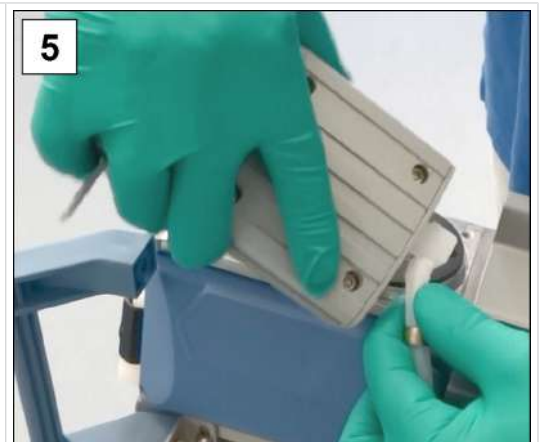
5. Ha minden szelep elhelyezése jó, először tegye fel a formázott tömlőt.
