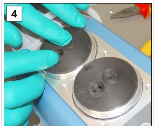
4. Aseta uudet venttiilit paikoilleen ja suuntaa ne; tiivistesarja nro 20696828.
