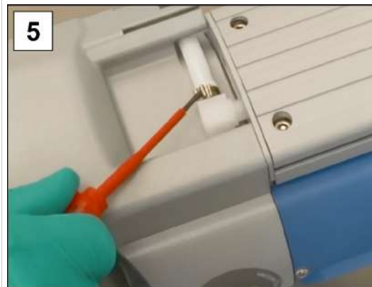
5. 打开软管夹；1号开槽螺丝刀。
