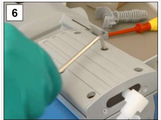
6. 旋出螺纹紧固件；4号内六角扳手。
