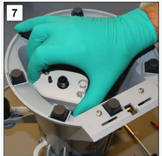
7. 拔下下部的 VACUUBUS 插头，取出传感器。
