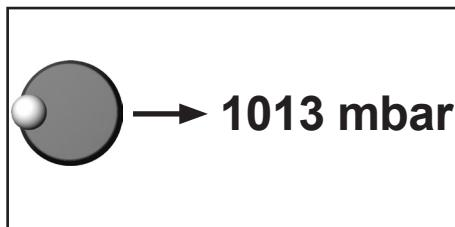
Il faut que la pression soit au-dessus de 700 mbar pour un ajustement par rapport à la pression atmosphérique.
