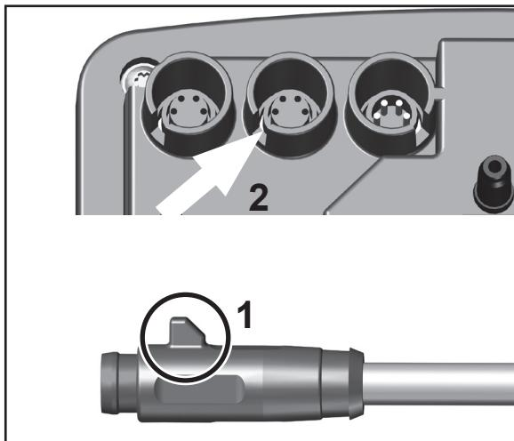
Dépendant de la version technique les câbles VACUU•BUS sont équipés avec un guide.
