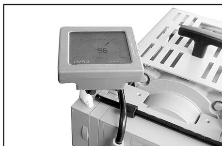
➔ En mesurant la pression à l'aspiration de chaque tête: Utilisez un vacuomètre approprié (p.ex. DVR 2pro, réf.: 20682906), en veillant à ce qu'il soit correctement étalonné, et mesurez le vide au côté d'aspiration. Une valeur de pression inférieure à 120 mbar doit être trouvée.
