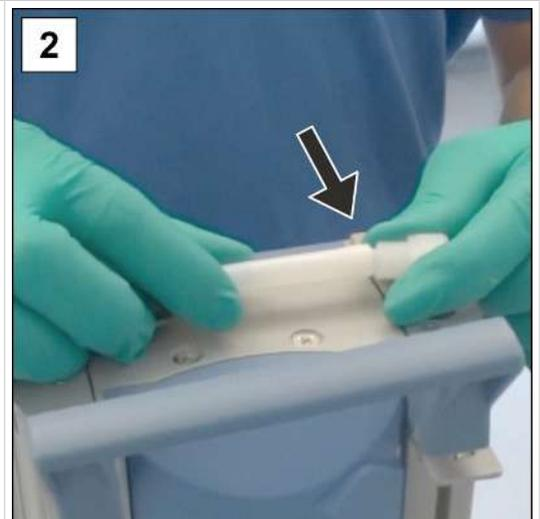
2. Tournez le raccord à vis cou-dé d'un quart de tour dans sa position initiale dans le tuyau modelé.
