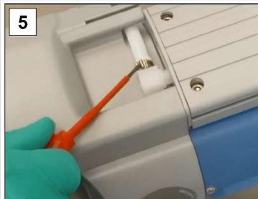
5. Ouvrez le collier de serrage pour tuyau à l'aide du tournevis à tête plate de taille 1.
