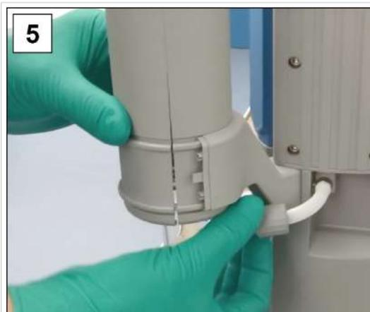
5. Desserrez l'écrou-raccord et débranchez le tuyau modélé.
