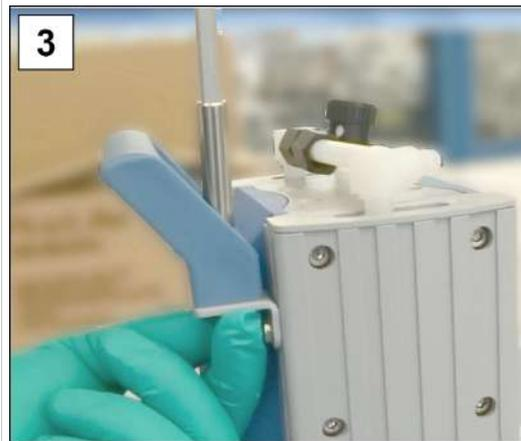
3. Desserrez la vis de la poignée à l'aide de la clé Allen de taille 5.
