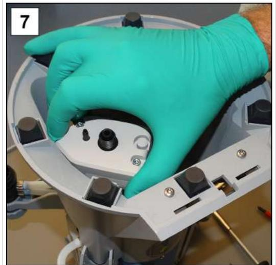
7. Débranchez le connecteur VACUU·BUS situé dessous, puis retirez le capteur.
