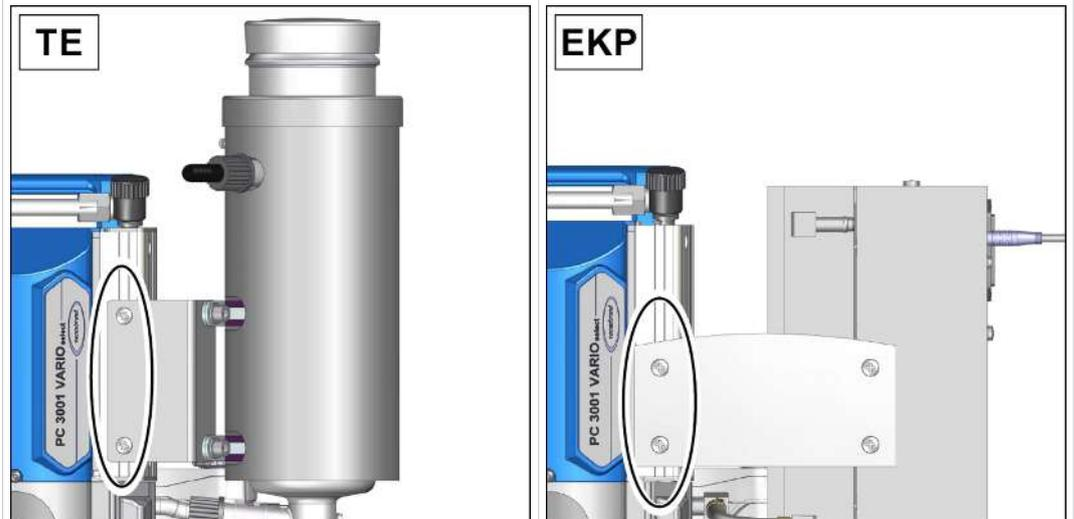
⇒ Dévissez les 2 vis de fixation à l'aide d'un tournevis cruciforme de taille 2.
