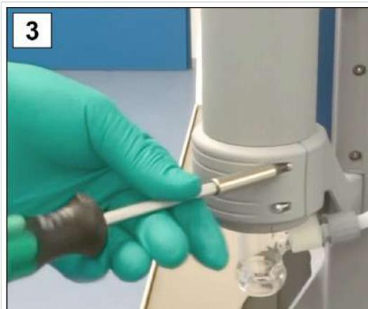
3. Dévissez les vis du support à l'aide d'un tournevis Torx TX10.
