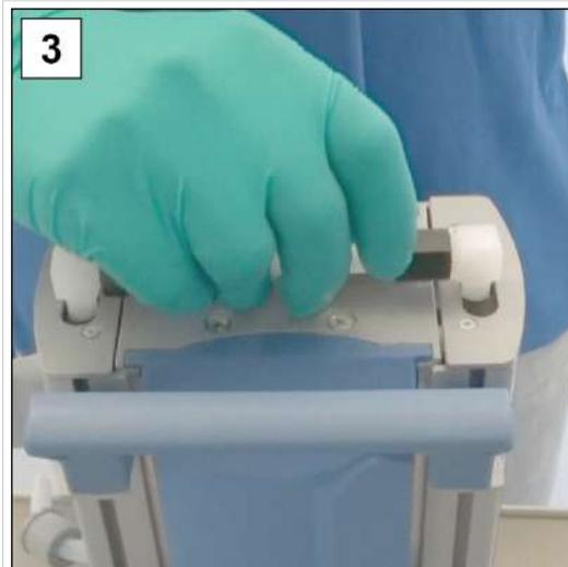
3. Serrez l'écrou-raccord fermement à l'aide de la clé à fourche SW17.
