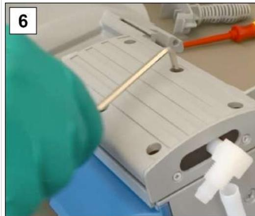
6. Posez le couvercle du boîtier à plat et revissez les vis à l'aide de la clé Allen taille 4, torque : 6 Nm.
