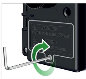
4. Coloque la tapa del compartimento de la batería con el tornillo en la posición correcta sobre el medidor. Enrosque el tornillo a mano. Al ajustar, tenga en cuenta el torque máximo de 0,4 Nm.
