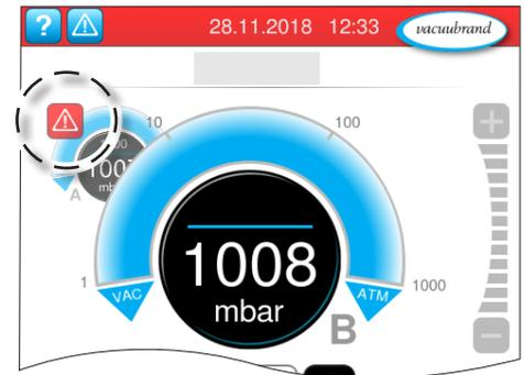
Warnungen und/oder Störungen werden in der blinkenden Druckkurve angezeigt. Wird diese Druckkurve angetippt, lässt sich der Prozess mit Störung aufrufen. Der Prozess ohne Störung läuft weiter. Sollten beide Prozesse von der Störung betroffen sein, stoppen beide Prozesse.
