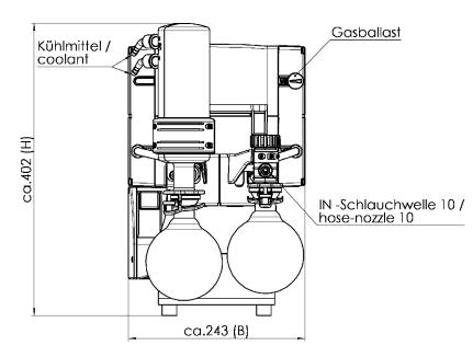
Alle Maße / all dimensions (mm) Gewicht / weight: 17,3 kg EX - Schlauchwelle 10 / hose-nozzle 10
