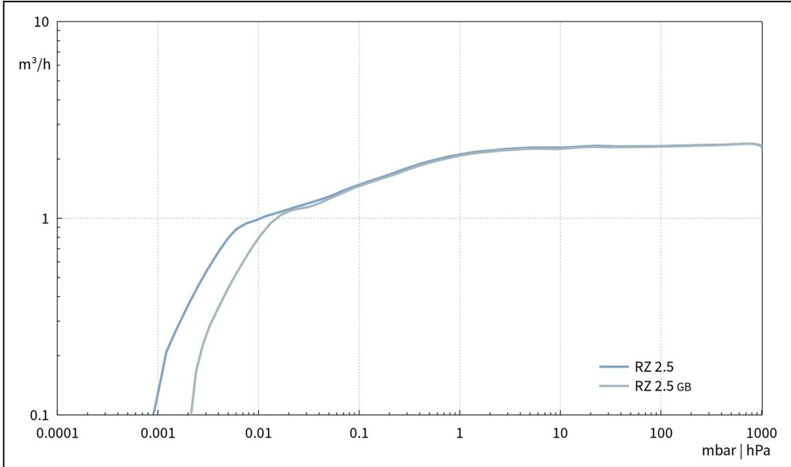
Abpumpkurve bei 50 Hz (10 l Behälter)
