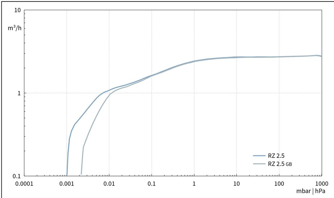
Abpumpkurve bei 60 Hz (10 l Behälter)
