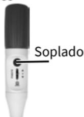
En cuanto el menisco en la punta de la pipeta se encuentre en reposo, presionar una vez el pequeño pulsador de soplado. Arrastrar algunos milímetros hacia arriba la punta de la pipeta por la pared del recipiente.
