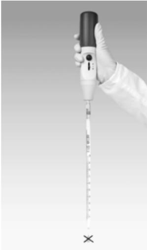
Nach dem Einstellen des Meniskus darf ohne Betätigung der Ventile keine Flüssigkeit aus der Pipette tropfen. Sollte die Pipette tropfen, siehe Störung - Was tun?, S. 17
