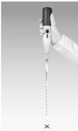
调整弯月面之后，如果不致动阀，则不得有液体从移液器中滴落。如果移液器滴液，参见 故障——如何处理？，
