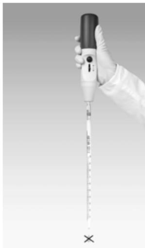
Após ajustar o menisco, nenhum líquido deve gotejar da pipeta sem acionar as válvulas. Se a pipeta gotejar, ver Avaria - O que fazer?, p. 142
