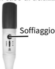
Non appena il menisco nella punta della pipetta si arresta, premere una volta il soffietto piccolo. Appoggiandosi sulla parete del recipiente, tirare la punta della pipetta di qualche millimetro verso l'alto.
