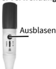
Sobald der Meniskus in der Pipettenspitze zum Stillstand gekommen ist, einmal den kleinen Ausblasbalg drücken. Pipettenspitze einige Millimeter an der Gefäßwand hochziehen.
