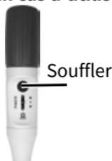
Dès que le ménisque s'arrête dans la pointe de la pipette, appuyer une fois sur le petit soufflet. Relever la pointe de la pipette sur quelques millimètres contre la paroi du récipient.
