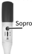
Assim que o menisco na ponta da pipeta ficar imobilizado, pressionar uma vez o pequeno fole de sopro. Levantar a ponta da pipeta alguns milímetros na parede do vaso.
